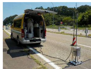
写真-2. 孔内全方位画像撮影状況
