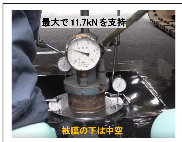
図-5 平板載荷状況
