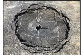
図-1 人工空洞 No. 3-1 陥没状況
