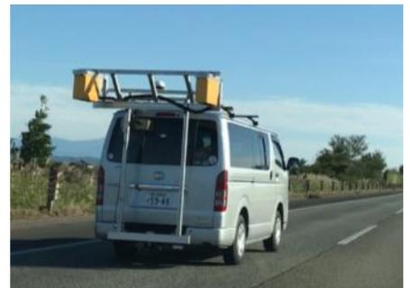
図 1 検査ユニットの装備車両
