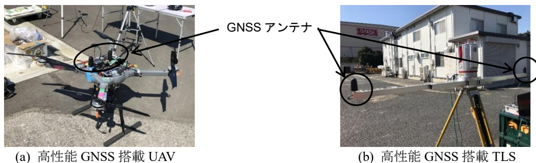
図-2 高性能 GNSS を搭載した計測機器
