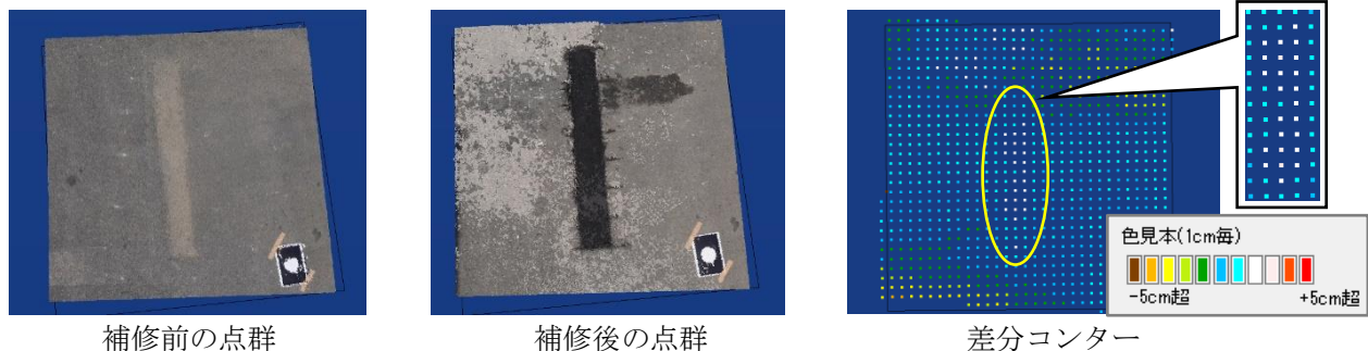
図-4 摩耗箇所の差分コンターによる補修状況の把握
