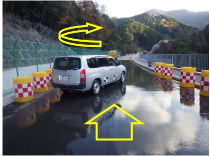
写真-2 急制動試験状況 （密粒度舗装）
