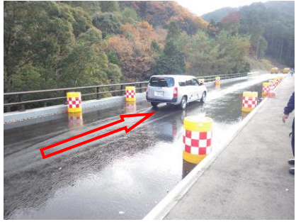
写真-1 急制動試験状況 （多機能型排水性舗装）
