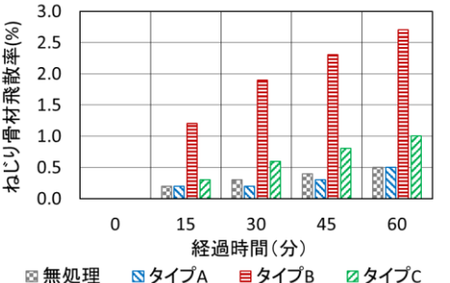
図-5 経過時間とねじり骨材飛散率
