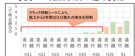
図3 ひび割れ率の経年変化
