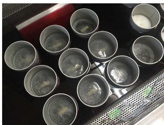
写真-1 凍結融解作用の実施状況
