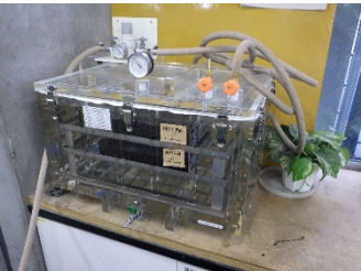
写真-2 強制浸水状況
