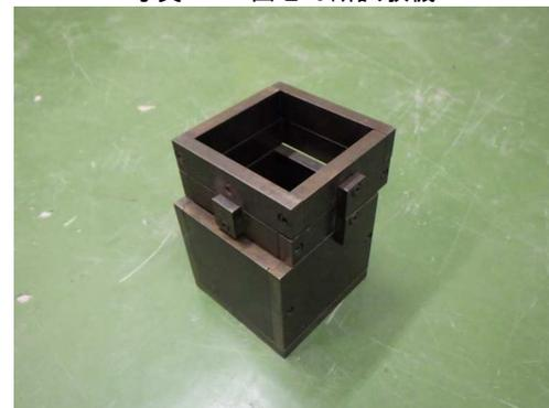
写真-2 一面せん断試験に用いるせん断箱
