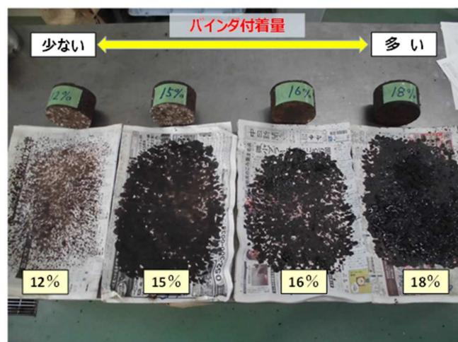
写真-1 余剰アスファルトモルタルのダレ
