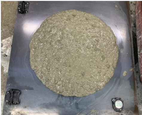
写真-1 No. 3 スランプフロー試験
