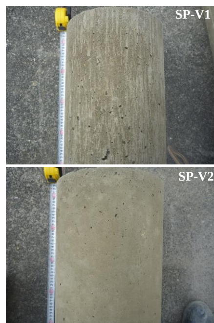
写真-2 \phi 300 \times h1800 mm 供試体の打込み上面付近の状況
