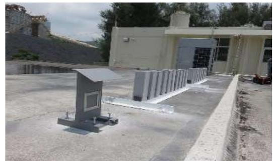
写真-1 ドライガーゼの設置状況
