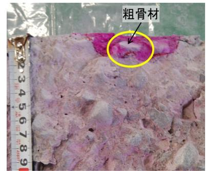
写真-3 水分浸透時の骨材の影響例
