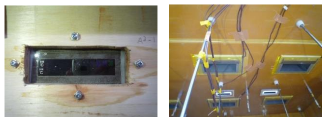
図-3 せき板サーモラベルおよび熱電対取付け
