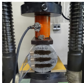
図1 割裂引張試験の状況
