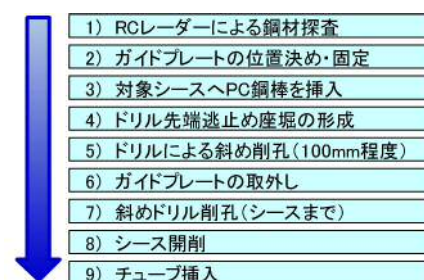
図-3 挿入兼注入孔形成手順
