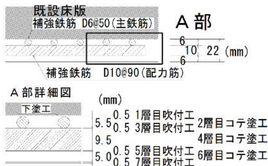
図-2 PSR 工法による増厚工 1)
