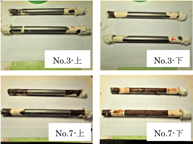
写真 1 通電実験後の鉄筋の外観
