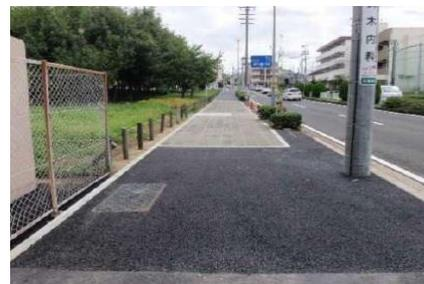
写真-3 透水性アスファルト舗装
