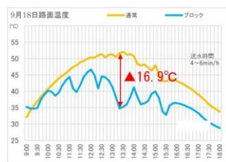
図-4 保水性アスファルト舗装①
