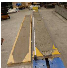
写真-2 Case1-4 充填完了状況
