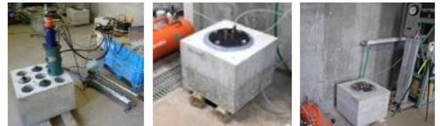
写真-2 付着強度試験
