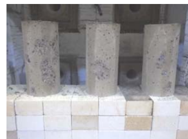
写真-3 加熱後の供試体状況
