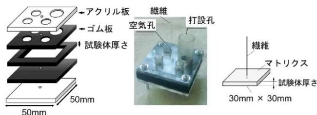
図-2 試験体および型枠形状
