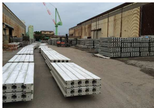
写真 2 出荷を待つ H 型 PC パイル
