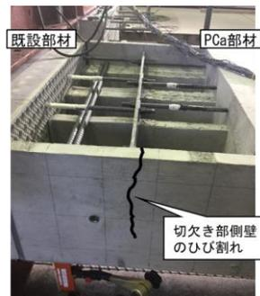
図-9 試験体のひび割れ状況
