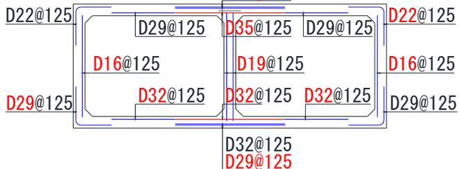
図-5 部分係数設計法による配筋略図（耐震）
