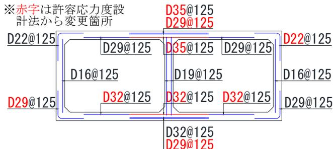
図-3 部分係数設計法による配筋略図（常時）
