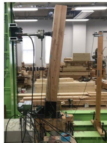
図-3 高欄支柱の水平荷重試験
