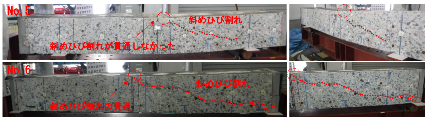
図-2 載荷試験後の状況
