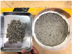
図-6 スケーリング試験
