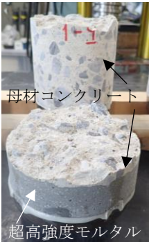
写真-3 試験体破壊状況
