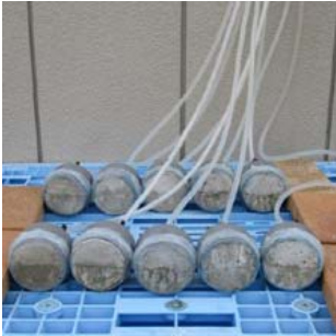
図5 ひび割れ透水試験
