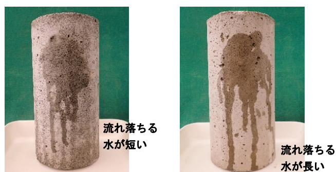
写真-1 供試体の外観 (左：塗布なし、右：塗布あり)
