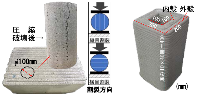
図-2 コア採取（割裂方向）および中空積層部材
