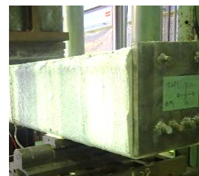
写真-7 梁部材の構築
