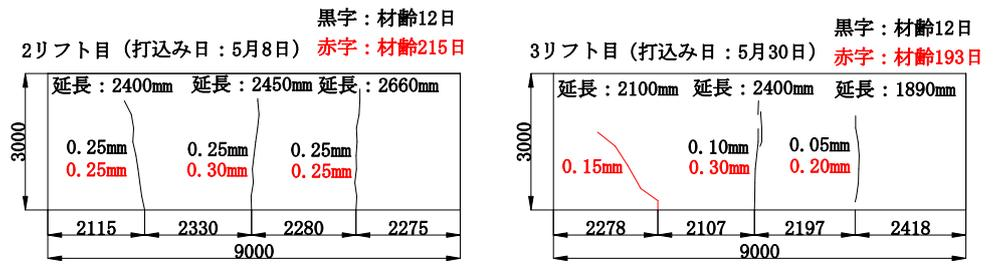
図-3 Case Nにおけるひび割れの発生状況（正面図）
