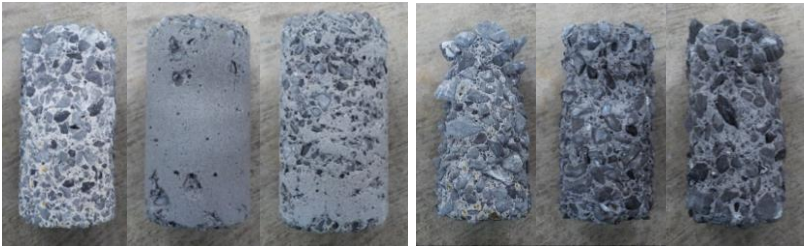
写真 1 5%(左), 15%(右)硫酸浸漬後の 供試体(左から OPC, TCR1, TCR2)
