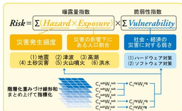
図-1 線形和を用いた GNS の概念図
