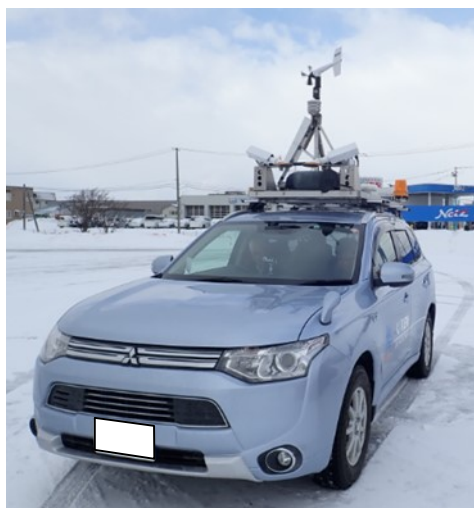
図3 観測に使用した移動気象観測車（ルーフ上に風向風速計を設置）
