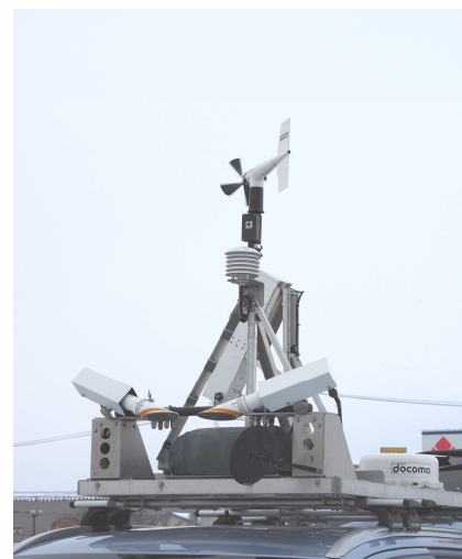
図3 観測に使用した移動気象観測車（ルーフ上に風向風速計を設置）
