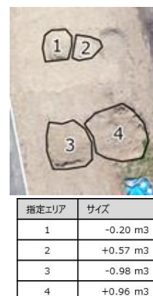
図 6. GIS による差分分布図（左）と指定エリアの体積集計（右）
