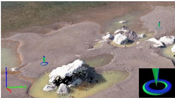
画像-4 3次元点群データ上でみる座標評価の様子
