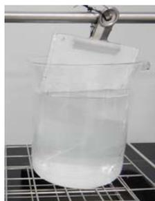
写真-1 吸水量試験
