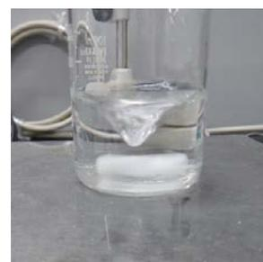
写真-2 吸水速度試験
