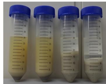
図3 遠心分離後の泥水 (左から凝集剤添加量 0g, 0.1g, 0.5g, 1.0g/水 100g (回転数: 3000 rpm, 遠心分離時間: 120 分))
