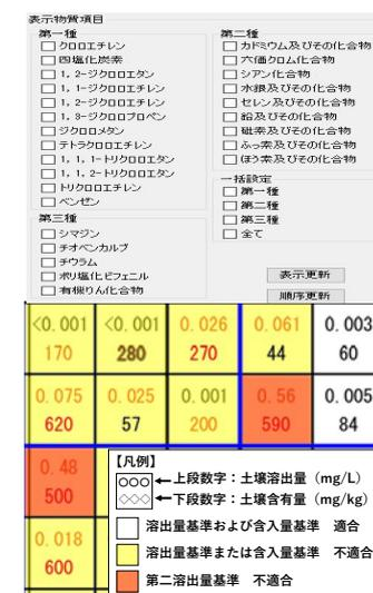
図-3 物質選択ダイアログ【上】、調査結果の図示【下】
