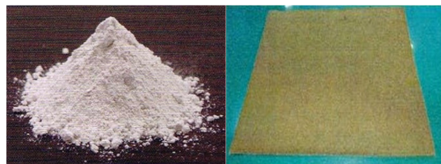
写真-1 Ca/Mg系複合材料（左）・シート資材（右）の外観
