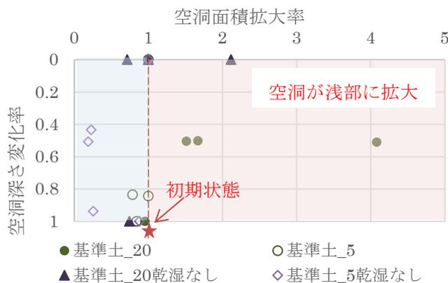
図3 空洞高さと空洞面積の関係
