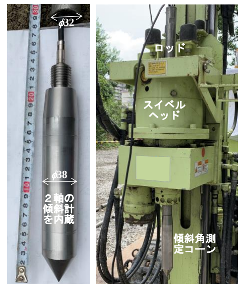
写真-1 傾斜角測定コーンと設置状況
