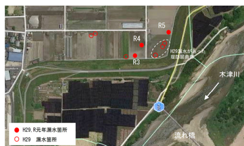
図-3 令和元年台風19号での漏水箇所
